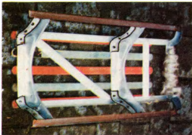
Перевернутые детские саночки, на которых черной обводкой обозначены установленные крепления.
